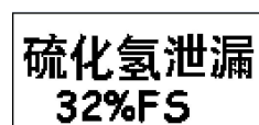
图 9 副屏幕远程硫化氢泄露显示 (远程接收到报警信息时蓝灯亮)
